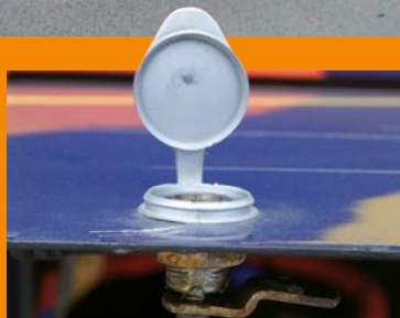
SCHUTZ vor Korrosion bieten die Abdeckungen an den Schlössern
